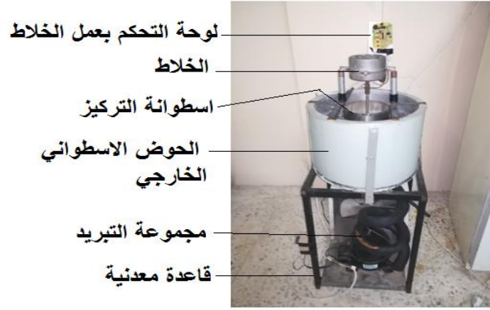
الصورة (1-3) جهاز التركيز بالتجميد المعلق
